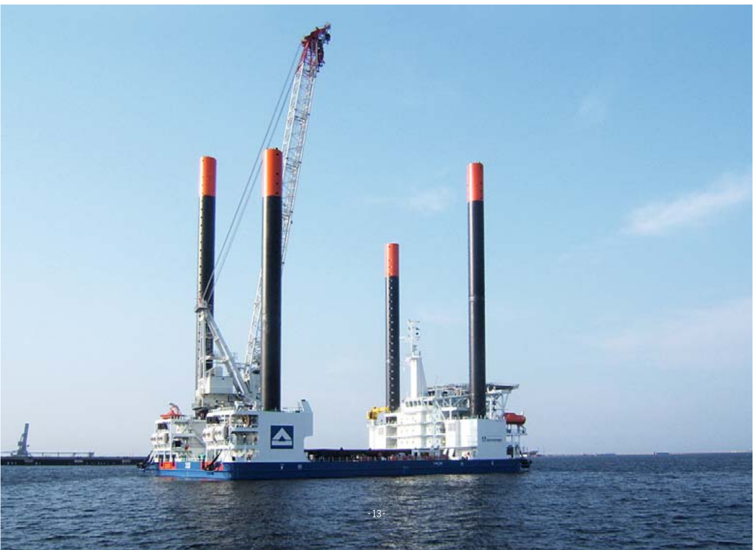
„Thor“ wurde insbesondere für die Errichtung von Offshore-Windenergieanlagen konstruiert.
